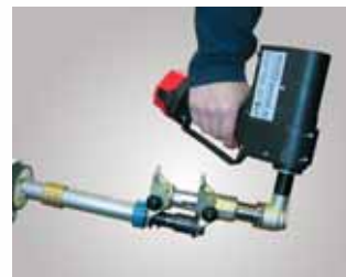
3. Metallpresskupplung verwenden und korrekten Sitz im Rohr überprüfen, Rohr aufweiten, um 30° drehen und wiederholen.
