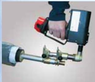
5. Hülse und Fitting in Presswerkzeug setzen.
