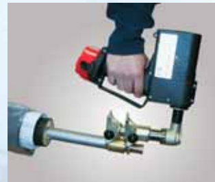
6. Hülse zum Fitting schieben.
